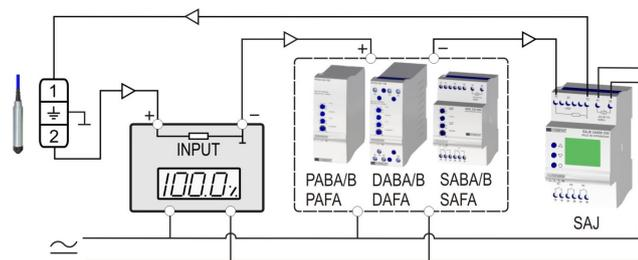
Alimentation du capteur et connexion à plusieurs modèles via la boucle de courant 4-20 mA.
